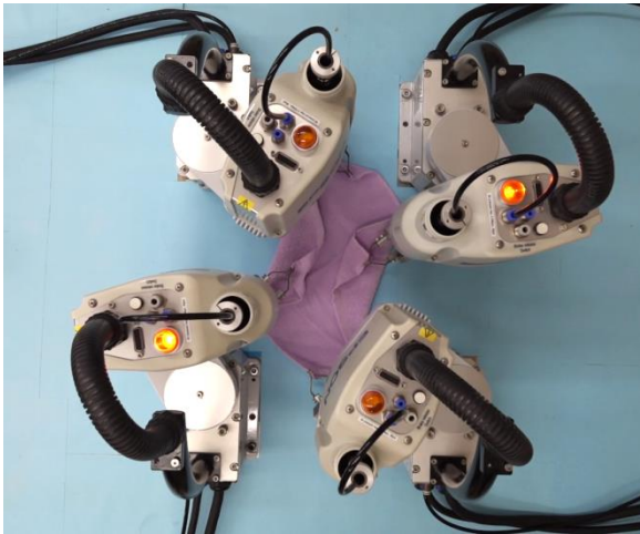
【SCARA によるハンカチの折り畳みと展開】(写真4)
