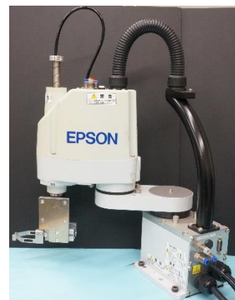
※【SCARA ロボット】(写真3)
