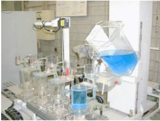
注湯ロボット
