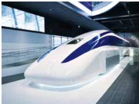
新館内に展示されているリニア実験車両 「MLX01-2」 2003年に世界最速の時速581 km/h を樹立
